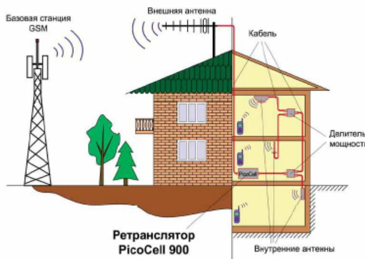
Ретранслятор работает следующим образом.
